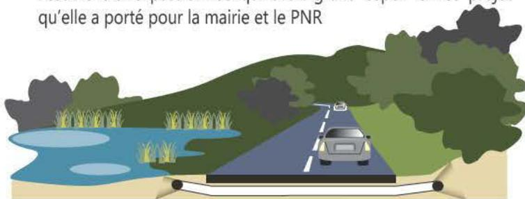
**Schéma de principe du dispositif à l'étude en simple conduit, à double sens de circulation : il permet le transit d'espèce de petite taille (amphibiens, reptiles, micromammifères)**
