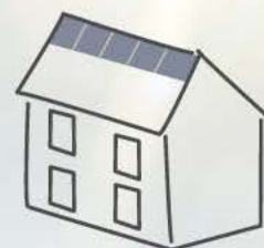
Panneaux alignés sur tout le faîtage
