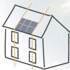
Panneaux alignés sur l'axe central des fenêtres
