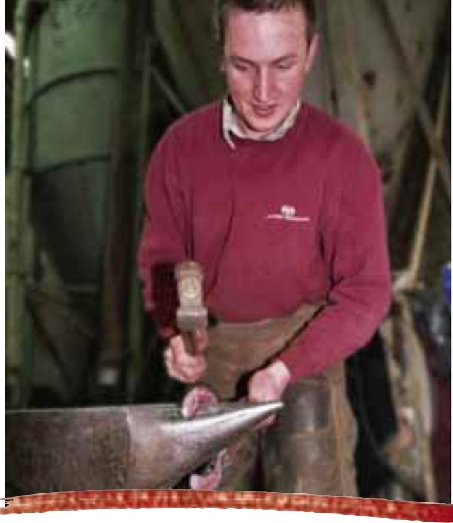
Le métier impose d'avoir un dos robuste: l'ouvrage nécessite d'être sans cesse courbé pour ôter le fer puis "parer" la corne, avant d'ajuster le nouveau fer sur le sabot, le brocher et enfin donner un dernier coup de lime pour la finition...
