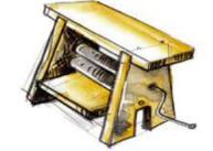
L'essoreuse accueille le linge mouillé entre ses deux rouleaux, pressé et essoré à l'aide de la manivelle.
