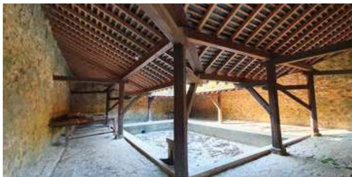
Le fond des bassins est généralement pavé ou dallé ou enduit au mortier pour les rendre imperméables et en faciliter le nettoyage. Les quatre côtés sont accessibles et dotés de margelles de lavage en pierre. Une vanne peut être installée pour gérer l'écoulement de l'eau, tandis qu'un déversoir peut permettre le débord du trop-plein.
