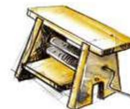
**L'essoreuse** accueille le linge mouillé entre ses deux rouleaux, pressé et essoré à l'aide de la manivelle.
